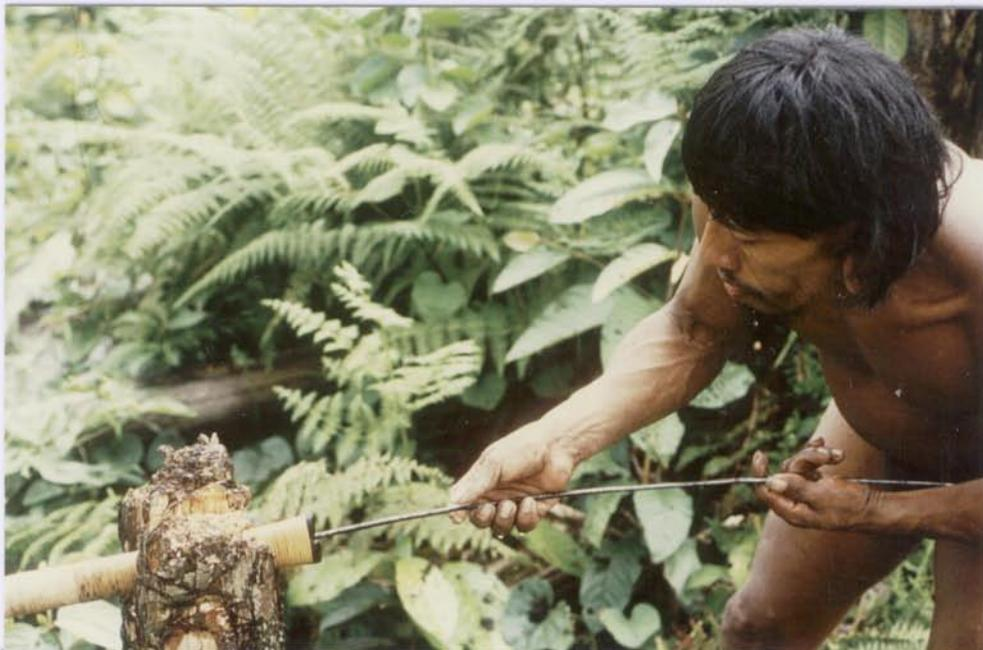
Mit einem langen, genau in den Schußkanal passenden Stab, an der Spitze mit Chambirafasern umwickelt ist, wird der Laufkanal durch Hin- und Herbewegen gleichmäßig geglättet.
