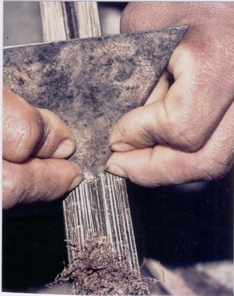
Zuerst muß mit einem Stück Metall des Buschmessers der Laufkanal herausgearbeitet werden, eine gekonnte und sehr mühsame Arbeit mit dem eisenharten Holz der Stachel- Palme (*Bactris gasipaes*).
