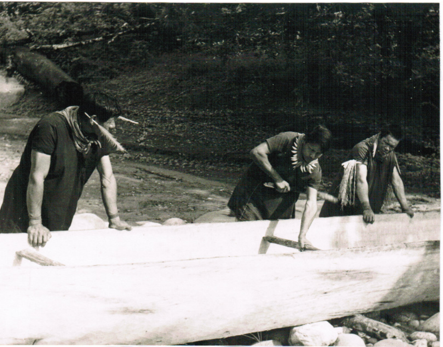
Guillermo und Cristobal beim Bau und Ausbrennen eines 11 Meter langen Einbaumes. Der fertig gestellte Einbaum wird zuvor mit Pflöcken geweitet.
